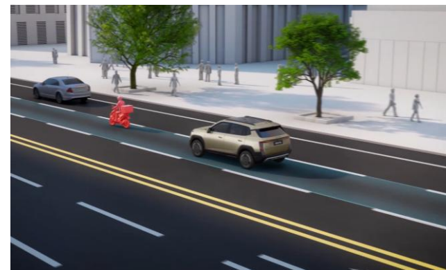
■ Система автоматического экстренного торможения
